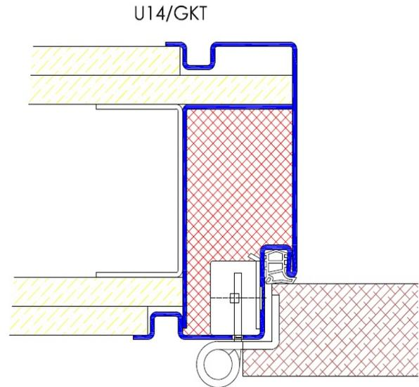
Profil U14 / Einbau in Betonschalung
