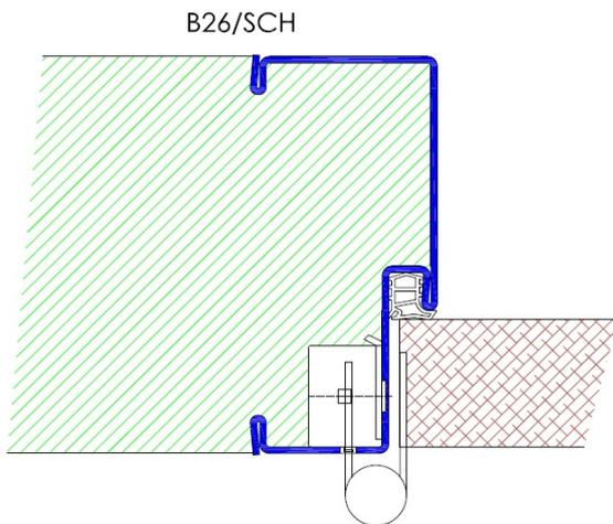
Profil B26 / Einbau mit Schraubmontage
