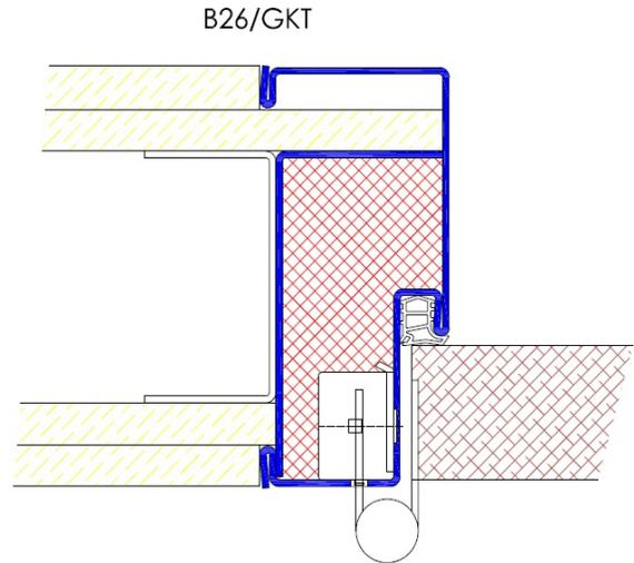
Profil B26 / Einbau in Betonschalung
