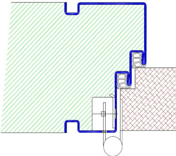
Profil B42 / Einbau mit Schraubmontage
