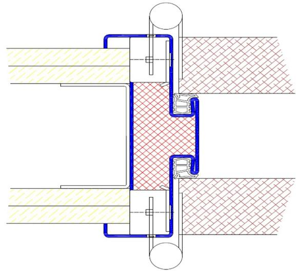
Profil Z20 / Einbau in Betonschalung
