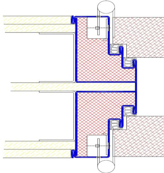
Profil Z46 / Einbau in Betonschalung
