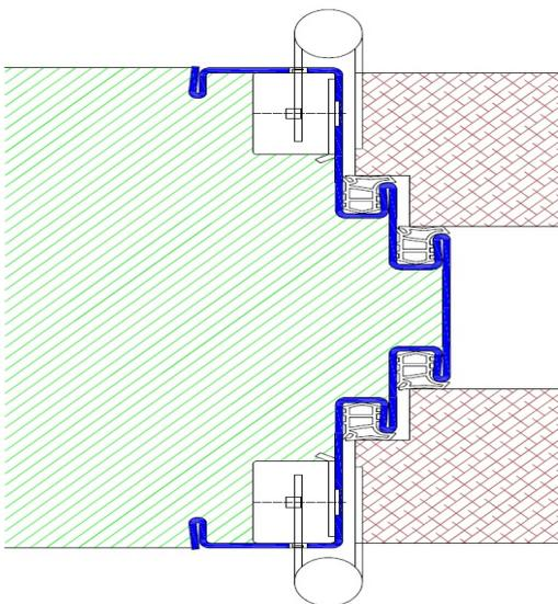
Profil Z46 / Einbau mit Schraubmontage
