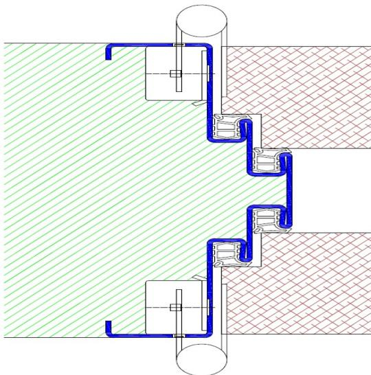
Profil Z40 / Einbau mit Schraubmontage
