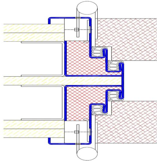
Profil Z40 / Einbau in Betonschalung
