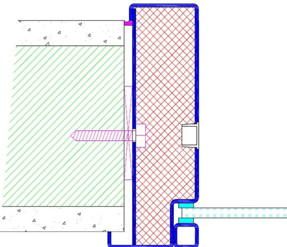
Profil F10 / Einbau in Betonschalung
