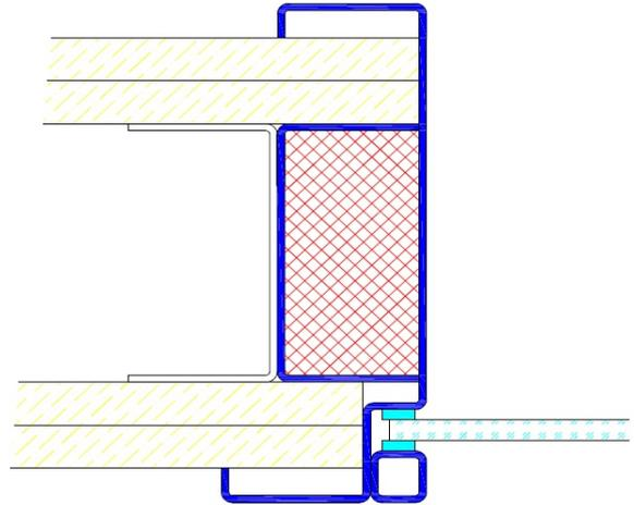
Profil F10 / Einbau mit Schraubmontage
