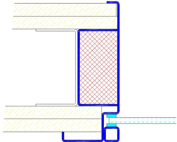
Profil F40 / Einbau mit Schraubmontage
