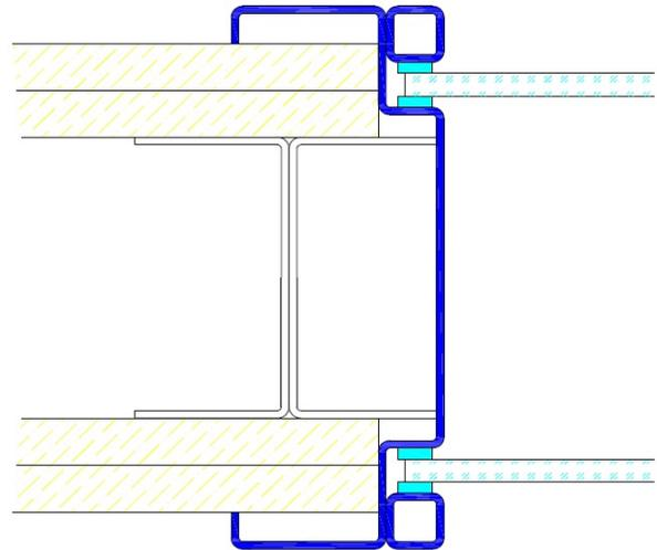
Profil F30 / Einbau mit Schraubmontage
