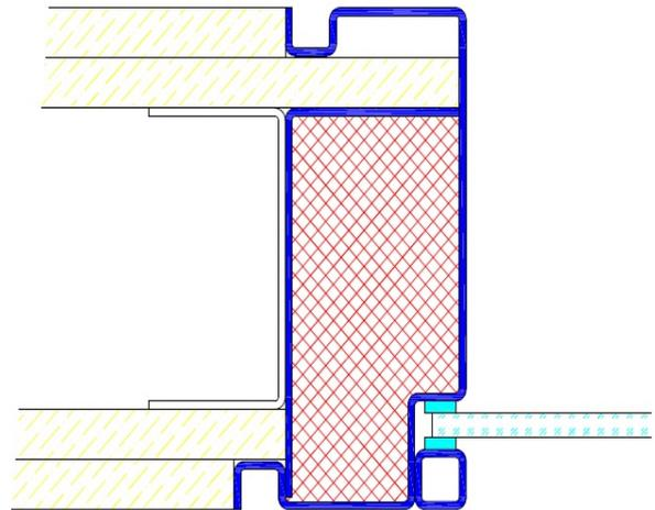
Profil F12 / Einbau in Betonschalung
