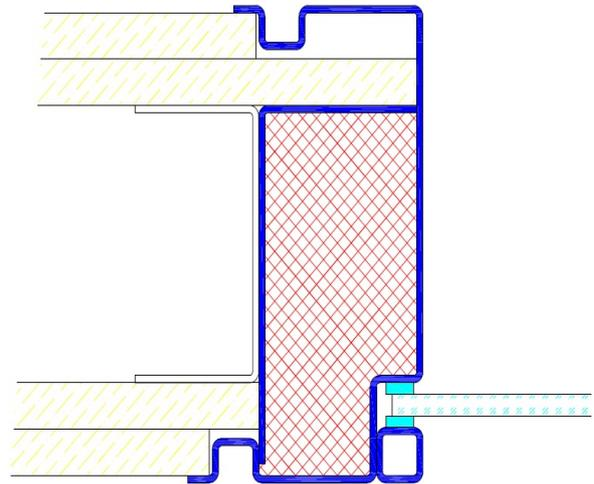
Profil F14 / Einbau in Betonschalung
