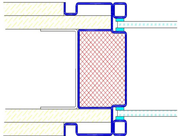
Profil F32 / Einbau in Betonschalung
