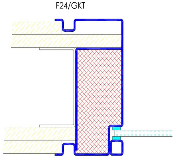
Profil F24 / Einbau in Betonschalung
