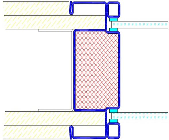
Profil F36 / Einbau in Betonschalung
