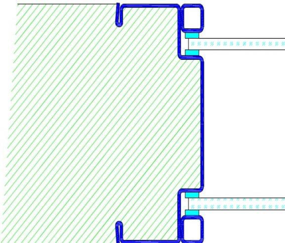
Profil F36 / Einbau mit Schraubmontage
