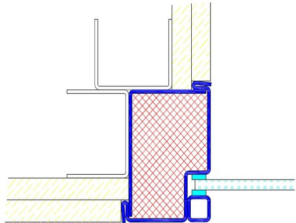
Profil F46 / Einbau in Betonschalung
