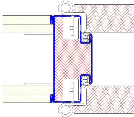
Profil Z16 / Einbau in Betonschalung
