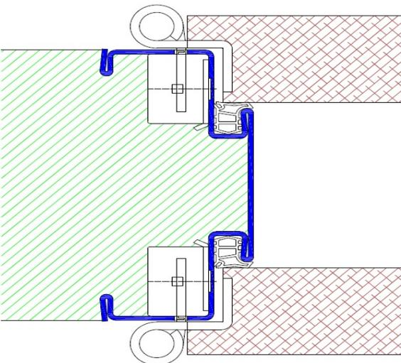
Profil Z16 / Einbau mit Schraubmontage
