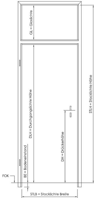
Kämpferprofil eingebaut in Zarge mit Seitenlichte
