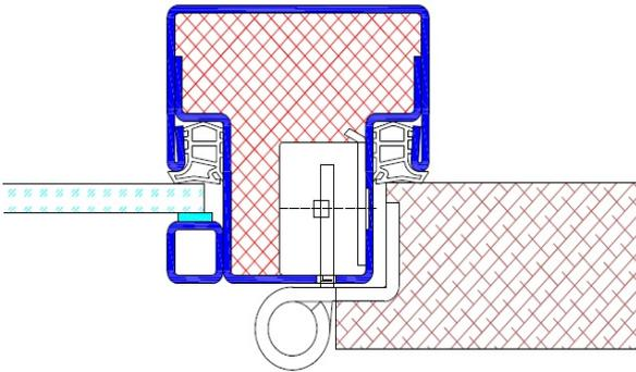
Profil K10 / mit eingebauter Schlossaufnahme
