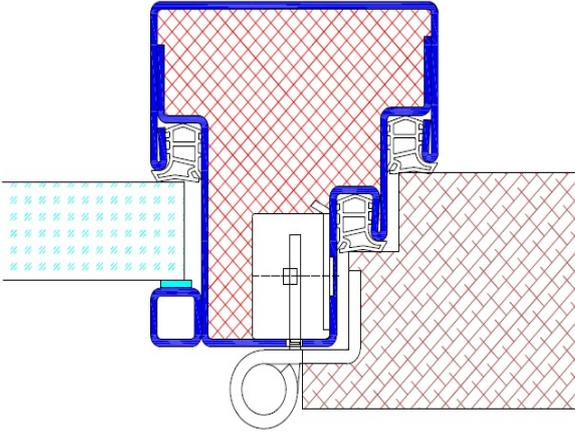
Profil K30 / mit eingebauter Schlossaufnahme
