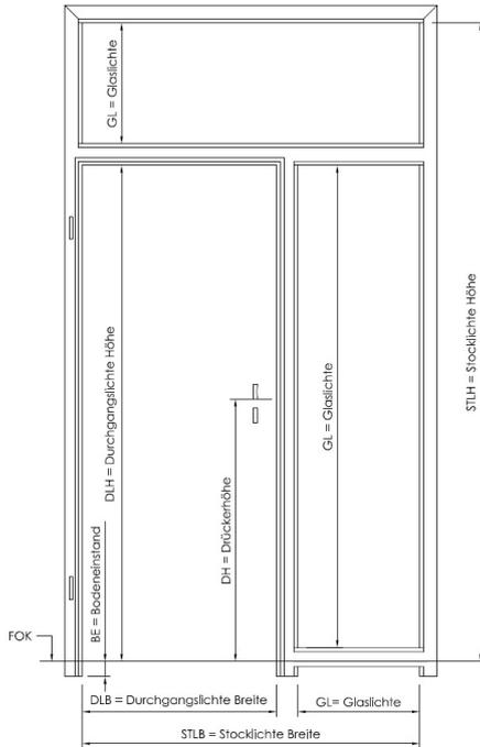
Kämpferprofil eingebaut in Zarge mit Ober- und 2-facher Seitenlichte
