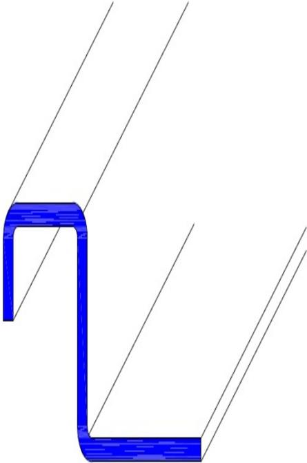
Z-Profil mit zusätzlicher Aussenkantung
