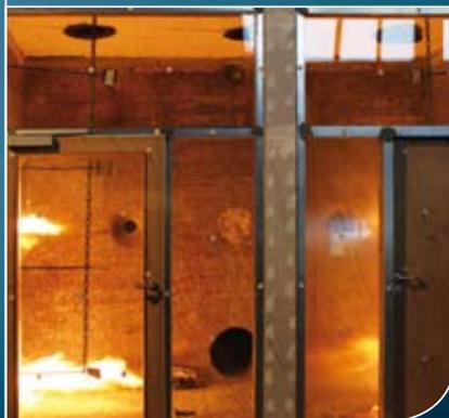
Mit der erfolgreichen Ablegung der Brandschutzprüfung durch das Institut für Brandschutztechnik und Sicherheitsforschung in Linz führen unsere Brandschutzzargen das ÖNORM-Zertifikat.
