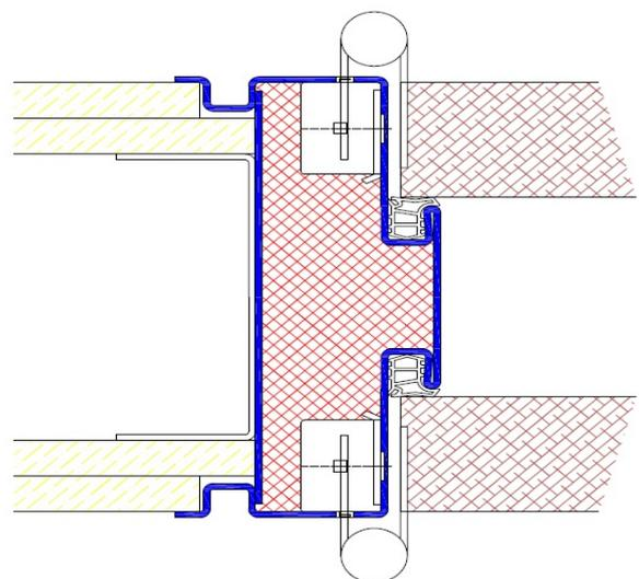
Profil Z24 / Einbau in Betonschalung
